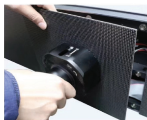
Manutenzione anteriore con moduli magnetici
