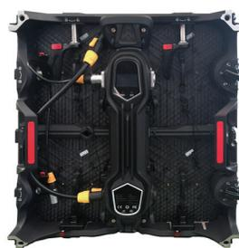
Power box completamente estraibile e sostituibile
