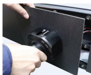
Manutenzione anteriore con moduli magnetici
